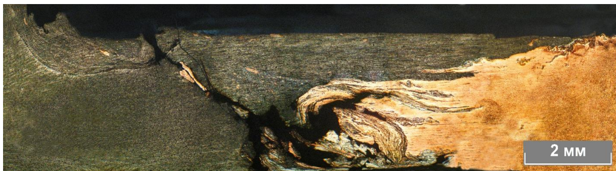
Рис. 5. Макрошлиф сварного разнородного соединения АД1 и М1 (1000 об/мин, 25 мм/мин, 3°)
